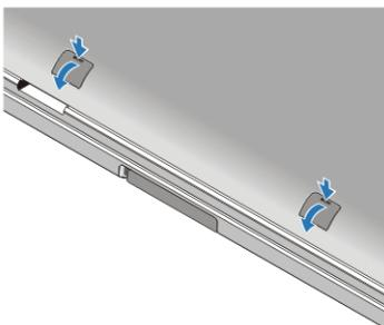
2. Coloque el ensamblaje del asa en los zócalos. Utilice los tornillos para ajustar y asegurar el ensamblaje del asa a la computadora.
